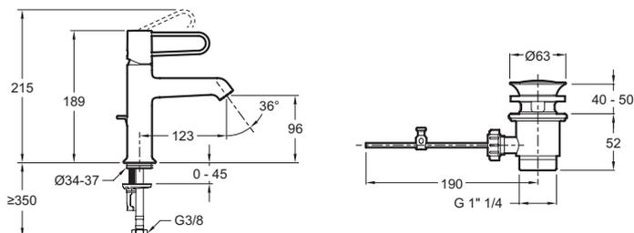
Спецификация продукта : Смеситель для раковины с донным клапаном. E21028-00. Коллекция : ODEON RIVE GAUCHE. ВЕС : 1.3 кг. МАТЕРИАЛ : N/A. ТИП УСТАНОВКИ : 1 отверстие. TYPE : Однорычажный. DÉBIT (L/MN SOUS 3 BARS) : 5 л/мин. HAUTEUR TOTALE DU ROBINET (MM) : 189. SAILLIE DU BEC (MM) : 123. RACCORDS : С гибкой подводкой. MÉCANISME : Керамический дисковый картридж.
