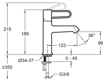
Спецификация продукта : Смеситель для раковины без донного клапана. E21029-CP. Коллекция : ODEON RIVE GAUCHE. ВЕС : 1 кг. МАТЕРИАЛ : N/A. ТИП УСТАНОВКИ : 1 отверстие. TYPE : Однорычажный. DÉBIT (L/MN SOUS 3 BARS) : 5 л/мин. HAUTEUR TOTALE DU ROBINET (MM) : 189. SAILLIE DU BEC (MM) : 123. RACCORDS : С гибкой подводкой. MÉCANISME : Керамический дисковый картридж.
