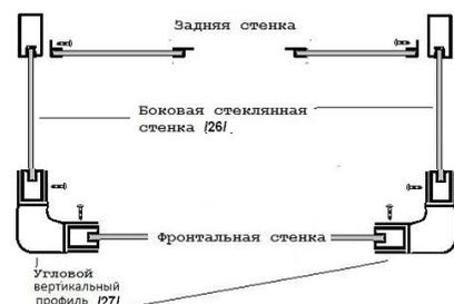
Выровняйте на поддоне каркас душевой кабины по переднему бортику, задние стенки выровняйте по заднему бортику, чтобы они стояли строго по одной линии, просверлите отверстия на поддоне соответственно отверстиям на нижних профилях задних стенок и соедините каркас душевой кабины с поддоном саморезами 4\*15 /47/ (рис.13).
