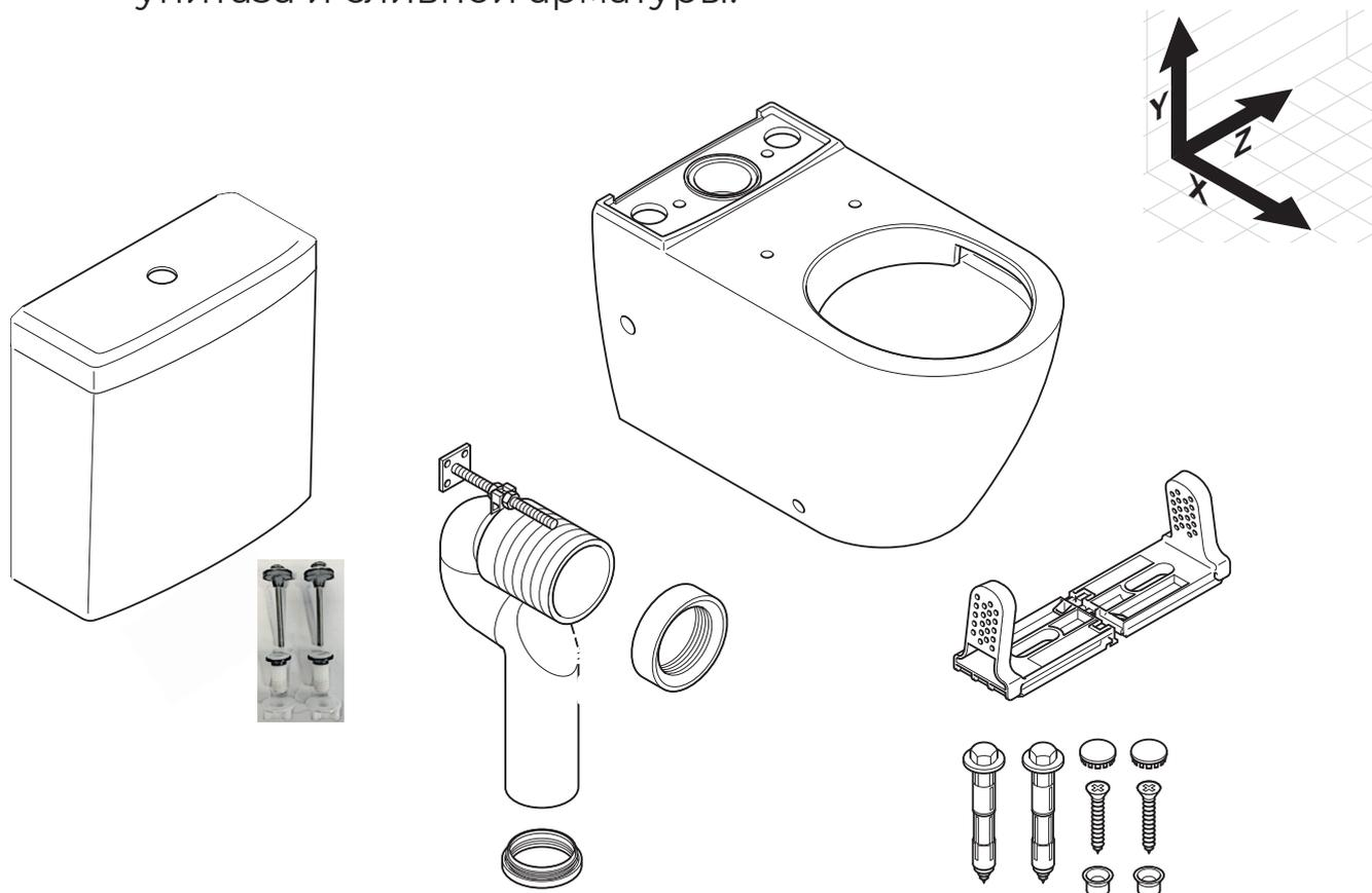
Установите чашу унитаза на место монтажа. На полу отметьте точки для установки крепления. Отодвиньте унитаз в сторону. По сделанным отметкам просверлите отверстия и закрепите крепежный кронштейн на пол с помощью прилагаемых винтов.
